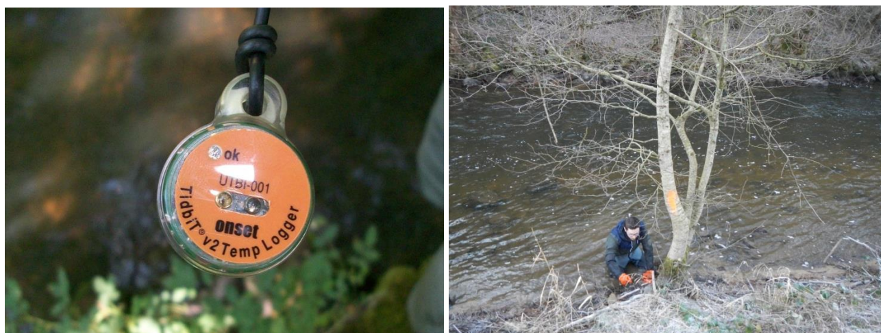
Figure 2 : Photographies d'une sonde thermique (à gauche) et de la pose de la sonde (à droite)
