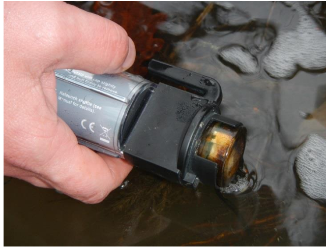
Figure 3 : Photographie de la récupération de données grâce à la navette étanche
