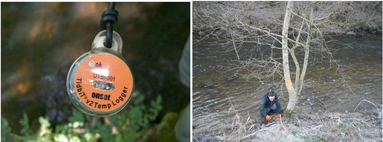
Figure 4 : Sonde enregistreuse de la température (à gauche) et pose de la sonde (à droite)
