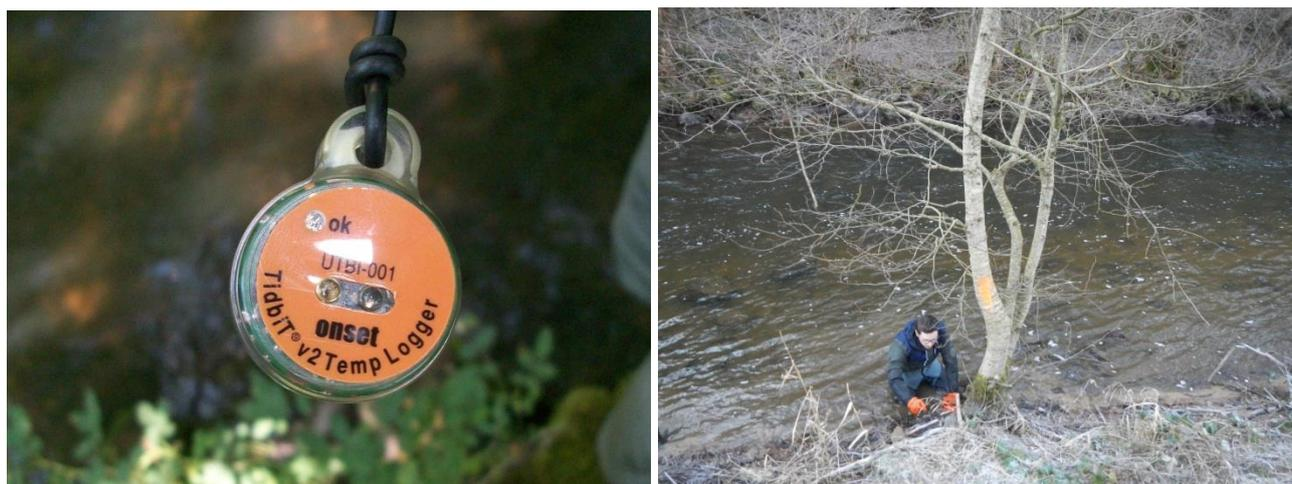
**Figure 2 : Photographies d'une sonde thermique (à gauche) et de la pose de la sonde (à droite)**
