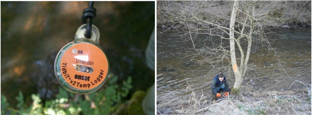
Figure 3 : Photographies d'une sonde thermique (à gauche) et de la pose de la sonde (à droite)
